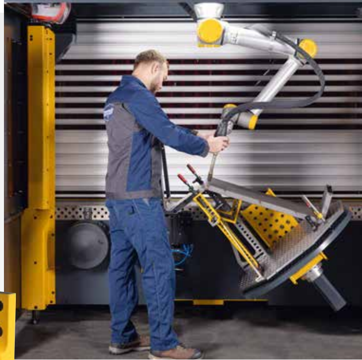
Coppia manipolatore (A2): 1000 Nm
