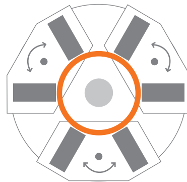
Serraggio INOZet® a 6 punti 6-point clamping with INOZet®
