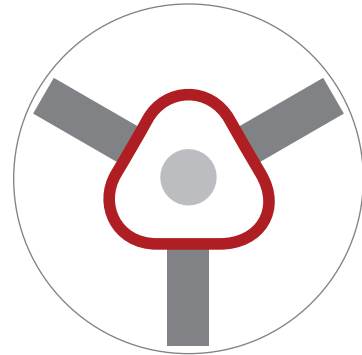
Serraggio convenzionale a 3 punti Conventional 3-point clamping
