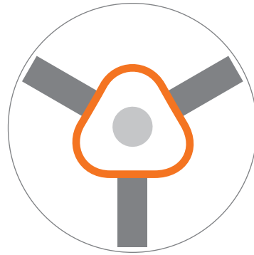
Serraggio convenzionale a 3 punti Conventional 3-point clamping
